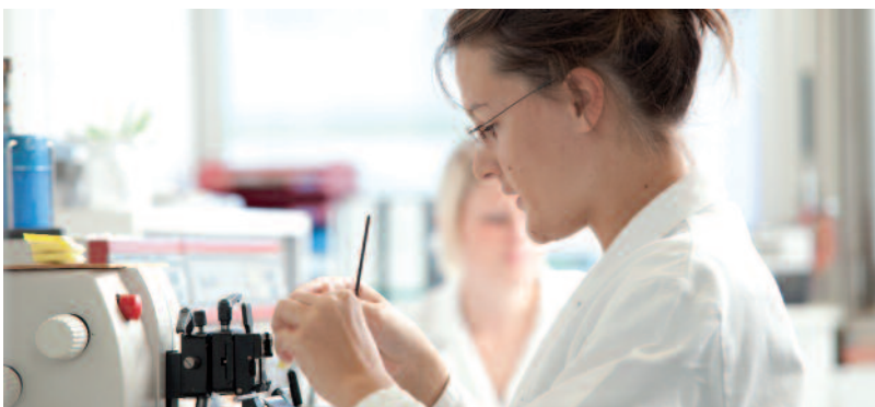
Mirijam Mahler, eine Kollegin von Sophia Riolini, vor einem Mikrotom. Ein Schneidegerät, mit dem sich dünne Schnitte von Präparaten realisieren lassen.
