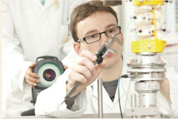
Markergestützte Bewegungsanalyse an Wirbelsäulensegmenten am Institut für Unfallchirurgische Forschung
