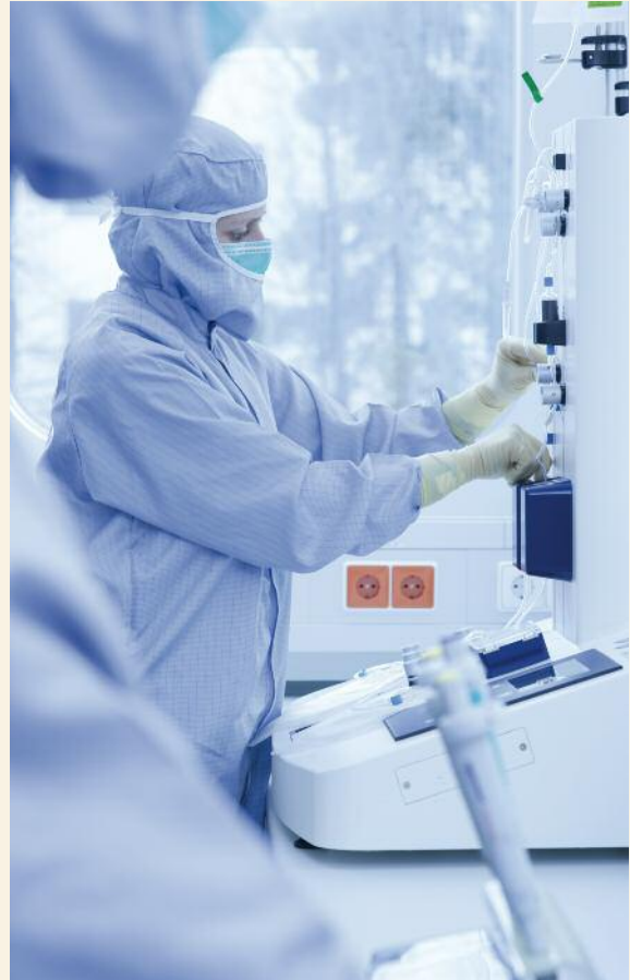
Immunmagnetselktion von CD34-positiven Blutstammzellen im GMP-Reinraum
