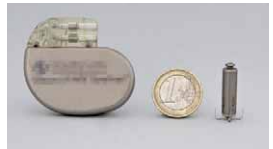
Herkömmlicher Schrittmacher und Herzschrittmacherkapsel. Foto: UK Ulm
