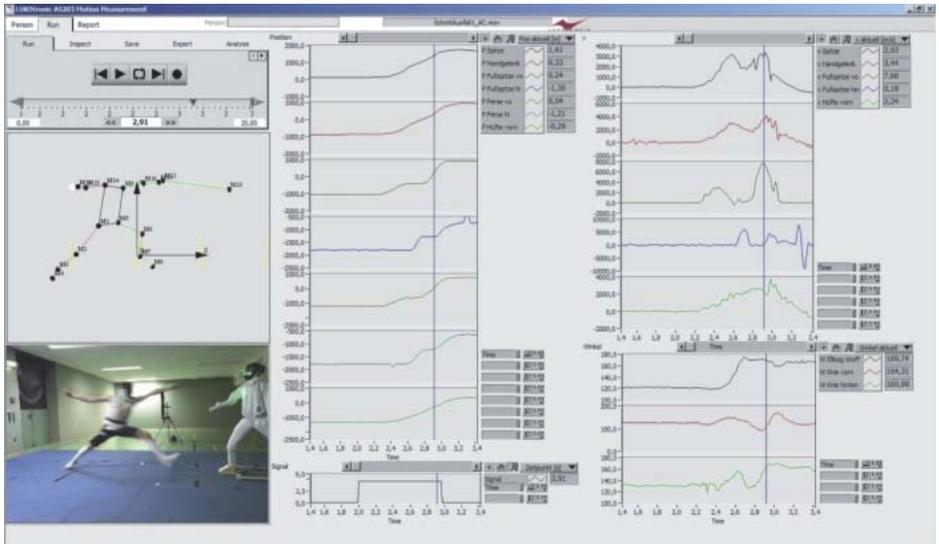
Bewegungen während der fechtspezifischen Aktionen wurden die Testpersonen jeweils mit 16 aktiven Infrarot-Markern ausgestattet. Mit Hilfe eines mobilen Motion-Capture-Systems (Lukotronik, Austria) mit sechs Infrarot-Kameras (2000Hz) konnten die Positionen, Winkel und Geschwindigkeiten der Marker exakt erfasst und Bewegungen dreidimensional analysiert werden.
