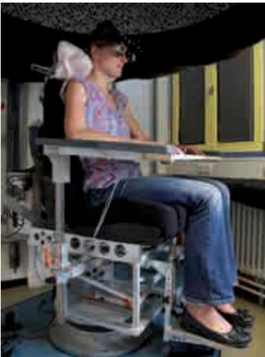
Drehstuhllabor mit Drehstuhl und opto-kinetischer Trommel
